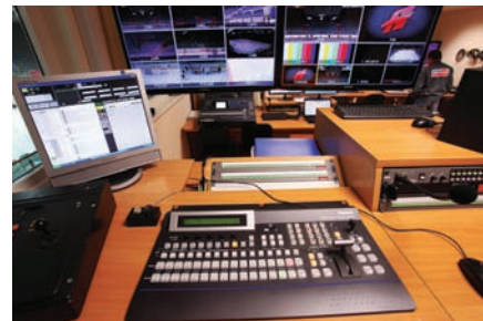
Видеосервер «Форвард ТА» и микшер Panasonic AV-HS450E – формирование сигнала для медиакуба
